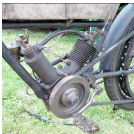
Lepape Bichrone 1903. Francouzská „ladepumpa“. Dvoutakt plněný předním válcem. Technických skvostů bylo na hradě Kámen k vidění mnoho
