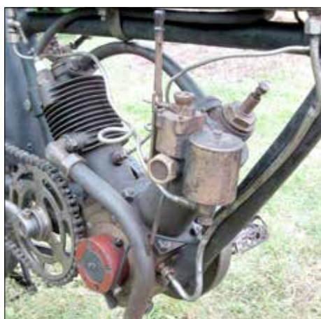
Lepape Bichrone 1903. Francouzská „ladepumpa“. Dvoutakt plněný předním válcem. Technických skvostů bylo na hradě Kámen k vidění mnoho
